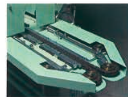
●キャリアチェーン ピンチ袋の袋上部をしっかりとかみこみ、袋を保持したまま、全工程を移行しますので、シールの位置ズレなどは起こりません。
