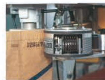
●印字機(オプション) ピンチシーラーと一体で印字するインク式自動プリンターです。マイクロスイッチによる1回転クラッチで定位置に印刷され、活字交換も非常に簡単です。
