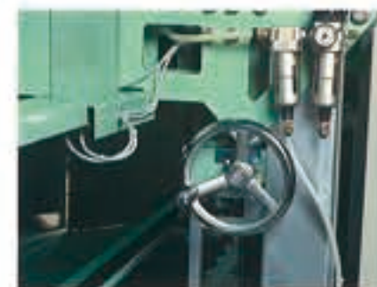
●袋高さ調整装置 ハンドル式で袋高さを調整できます。シール部全体が同時に上下します。ハンドル操作だけで、袋高さ調整が短時間でこなせます。
