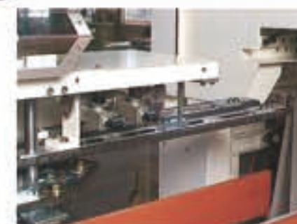
●挟み込み装置(自動包装機接続用) 袋を正確に送袋するために、挿入口に設けられているガイドです。両先端が左右に開いて袋を導入したあと、挟み込んで確実に送袋します。
