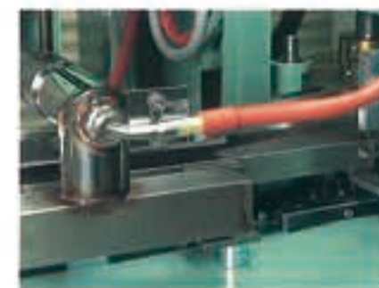
●温風ヒーター(クローザーヒーター) 袋上部の接着面に塗布されたホットメルトグルーを溶解させるため、無数の細穴から熱風を均一に吹き付けます。ピンチシーラーの心臓部で、高精度・堅牢性を誇ります。
