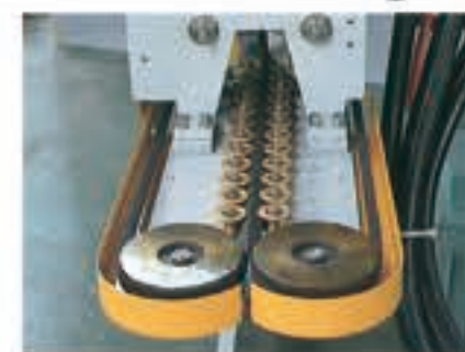
●袋保持ベルト ピンチ袋の袋保持がベルト方式なので、袋自体にキズが残らず、美しい包装ができます。袋保持が確実にスムーズな送袋方式です。
