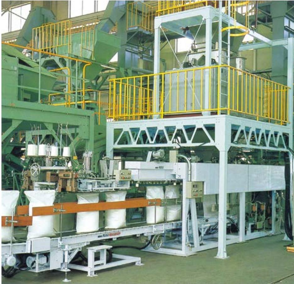
●40kg尿素用ポリクロス袋包装の3CM-PDです。2連式軽量機が2台据え付けられています。
